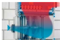
Вентиляция корпуса с помощью вентилируемых фланцев
